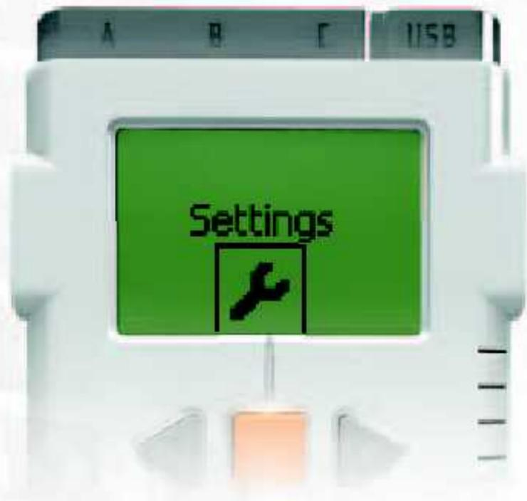
Le sous-menu Settings (Paramètres) vous permet d'ajuster les paramètres du NXT, comme le volume du haut-parleur ou les réglages du mode Sleep (Veille). Ce sous-menu permet également de supprimer les programmes stockés dans la mémoire du NXT.
