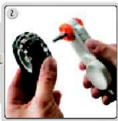
2 Fixez une roue au moteur et mesurez le nombre de rotations lorsque vous faites tourner la roue sur le sol.
