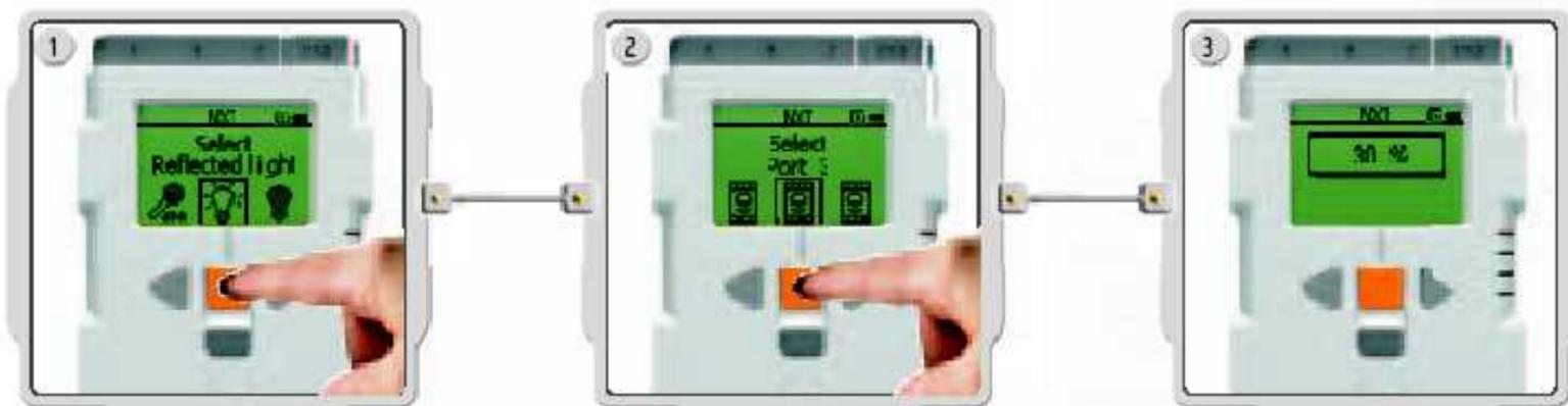
1 Sélectionnez l'icône du capteur ou du moteur que vous voulez tester. Vous ne pouvez obtenir des relevés que d'un capteur ou moteur à la fois.
