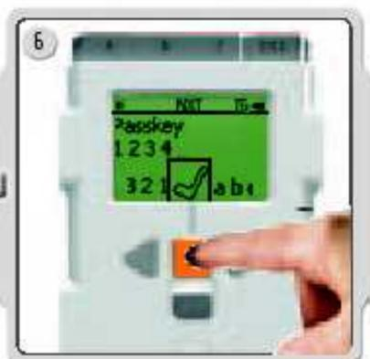
Entrez la clé de protection sur votre NXT et confirmez la connexion en appuyant sur le bouton orange [Entrée]. Si vous avez choisi la clé de protection par défaut, il suffit d'appuyer sur le bouton orange [Entrée].
