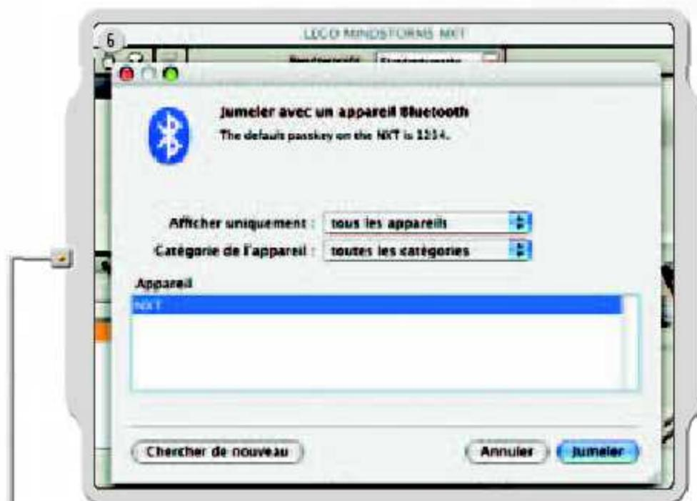
La fenêtre Pair with a Bluetooth Device (Jumeler avec un appareil Bluetooth) s'affiche. Sélectionnez le NXT. Cliquez sur Liaison.
