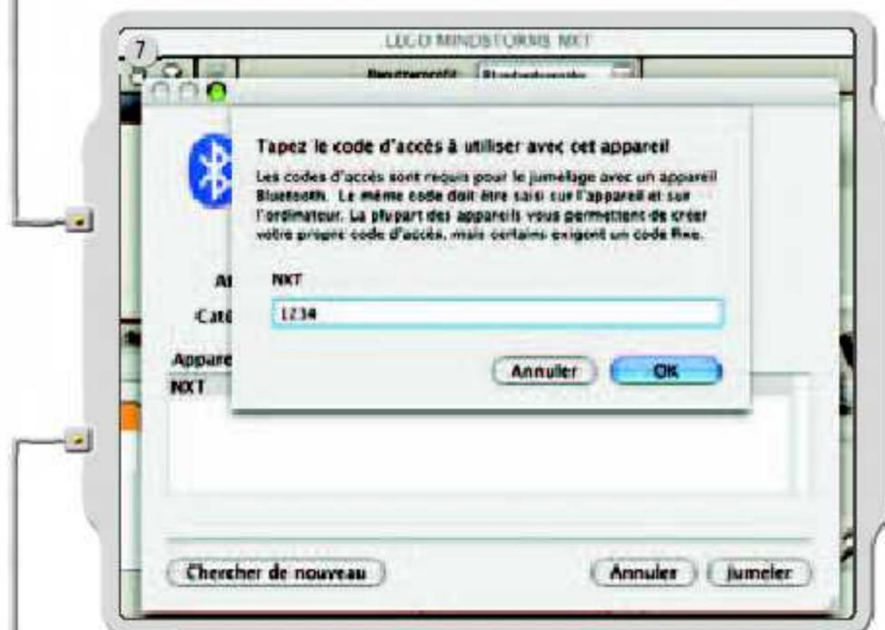
Lorsque vous vous connectez à un appareil pour la première fois, la fenêtre Clé de protection s'affiche. Entrez la clé de protection à utiliser avec cet appareil (la clé par défaut est 1234), puis cliquez sur OK.
