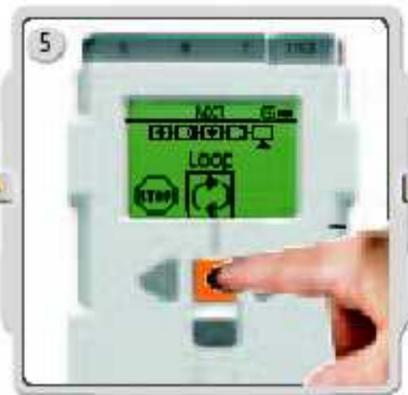
Indiquez à présent si le programme doit effectuer une boucle [loop]. Ceci signifie que le programme s'exécutera sans arrêt jusqu'à ce que vous éteigniez le NXT. Dans le cadre de ce test, sélectionnez Loop.
